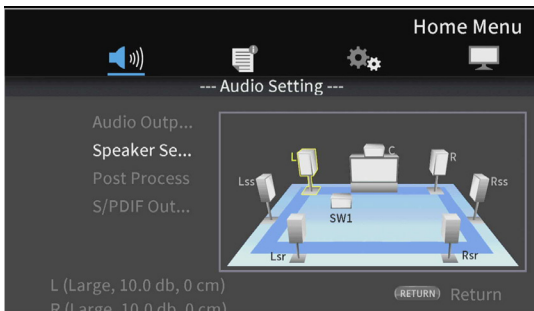
Beispiel mit 7.x und der Konfiguration C + LR + LssRss + LsrRsr
